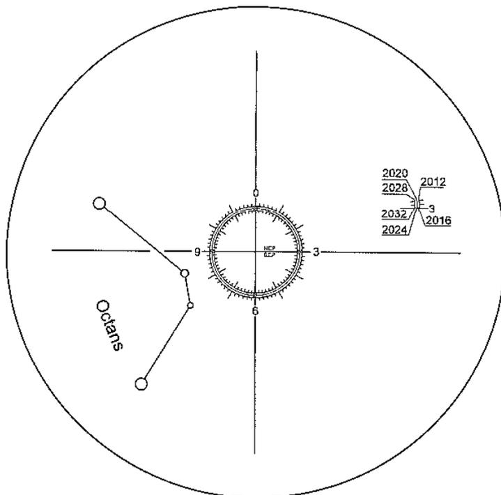
Il nuovo cannocchiale polare SkyWatcher include un reticolo inciso aggiornato per adeguarlo allo spostamento della Polare causato dalla precessione.
